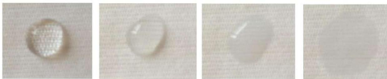
**Рис. 1. Диффузия капли жидкости полотном**
